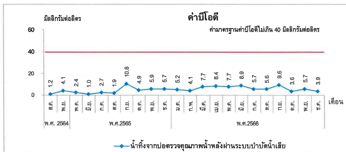
รูปที่ 3.4.1-2 กราฟเปรียบเทียบผลการตรวจวัดคุณภาพน้ำทิ้งจากบ่อตรวจคุณภาพน้ำหลังผ่านระบบบำบัดน้ำเสีย ระหว่างปี พ.ศ.2564-2566
